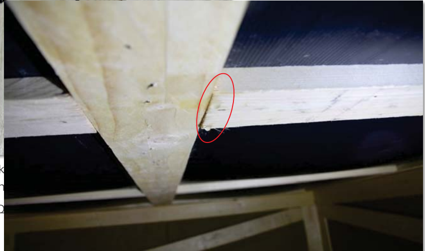
Kistendeckel A mit Blick auf den Stoß und Wassertropfenbildung (Variante A; 100 \frac{L}{m^2h} ; Tabelle 1, Quadrant E5, 15 min)
