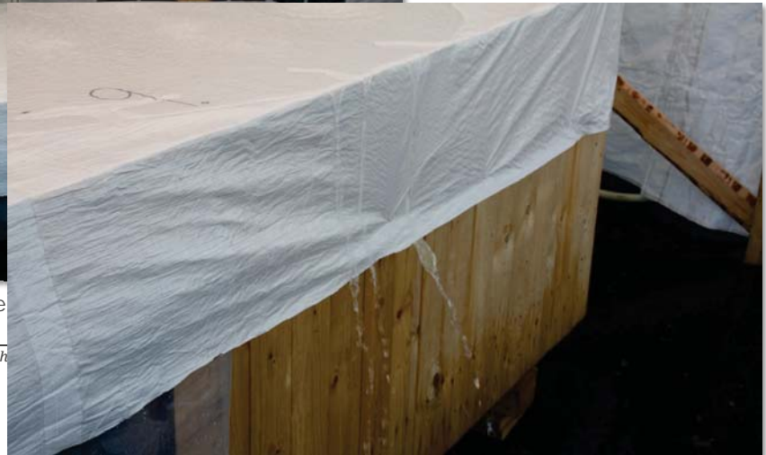
Detailansicht Kistendeckel B mit Blick auf das seitlich ab- laufende Wasser
