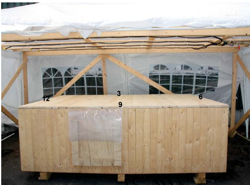
Übersichtsaufnahme der Beregnungsanlage mit Blick auf einen austauschbaren Kistendeckel mit Unterbau und Zollluke sowie dem Wasserverteilungssystem
