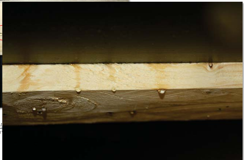
Teilübersicht Kistendeckels A mit Blick auf Wassertropfenansammlung an der Leiste unter der Akyluxsperrschicht (Variante A; 100 \frac{L}{m^2} ; Tabelle 1, Quadrant E9, 30 min)
