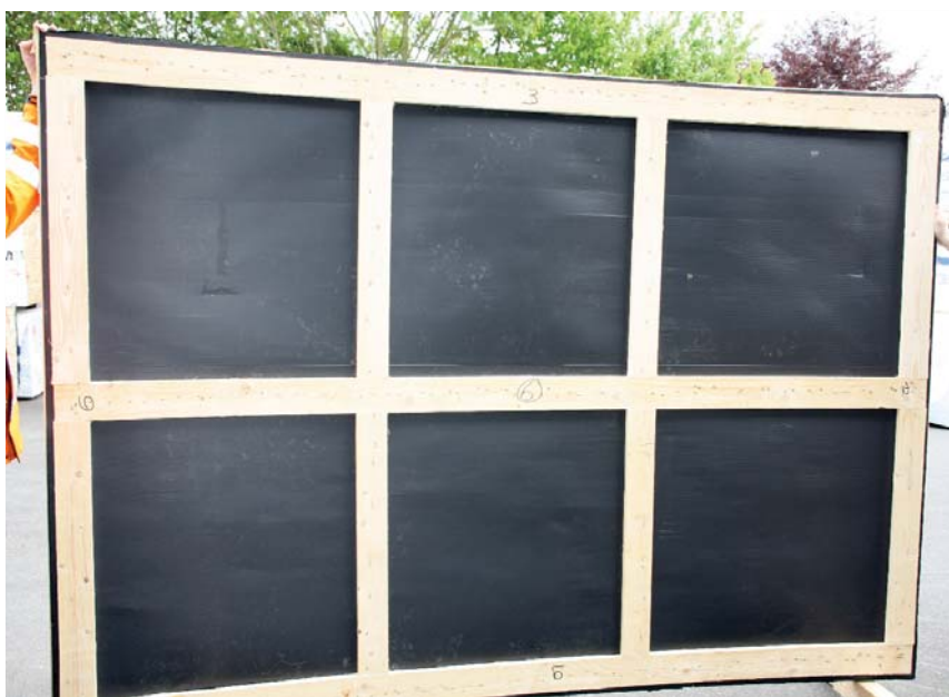
Übersichtsaufnahme der Unterseite des Kistendeckels A (ungeteilte Akyluxplatte mit durchgehender Polyethylen-Plane)
