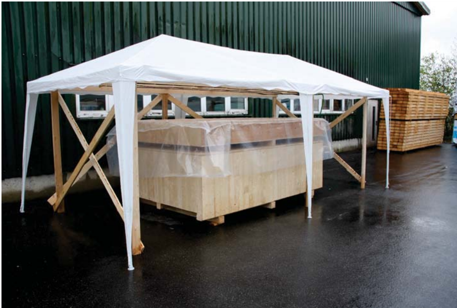
Übersichtsaufnahme der Beregnungsanlage mit Blick auf Kistendeckel und Kistenunterbaukonstruktion, dem Regenauffangbecken und dem Wasserverteilungssystem
